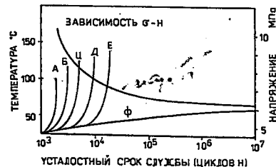
Рис. 17 Зависимость усталостного срока службы (до разрушения) от напряжения высококристаллического полимера (политетрафторэтилена) при частоте 30 Гц и возрастание температуры во время циклической нагрузки /75/
