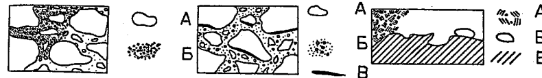
Рис. 2 а - Диаграмма структуры раствора (А - частицы песка, В - цементный гель и негидратированный цемент) б - Диаграмма структуры бетона (А - частицы крупного щебня, В - раствор, В - усадочные трещины, воздушные или водяные раковины) в - Диаграмма границы раздела между цементным вяжущим и частицами заполнителя (А - затвердевшее цементное вяжущее, В - воздушный пузырь, В - частицы щебня или песка)
